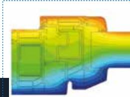
Legend Sistemi, 80 mm oturma genişliğine göre, 6 odalı olarak tasarlanmıştır. Sistemin tasarımında özellikle yüksek performans kriterleri göz önünde bulundurularak, profiller en uygun yapı taşlarının bir araya getirilmesi ile oluşturulmuştur. Tasarım süreci, profilen yanı sıra, pencere performansı olarak, yalıtım (ısı ve ses), mukavemet, sızdırmazlık özellikleri bütünsel olarak değerlendirilmiştir. Sistemdeki profiller, TS5358-EN12608 standardına uygun olarak üretilmektedir.
